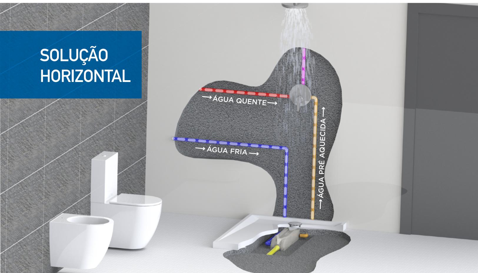
ZYPHO transfere o calor da água desperdiçada do duche (40°) para a entrada de água fria (10°). Essa água pré-aquecida (até 31°) é então direcionada à torneira misturadora do chuveiro, ao esquentador de água ou, de preferência a ambos - reduzindo o consumo de energia entre 30% a 67% - Melhorando assim a eficiência energética. A cada três banhos, dois são gratuitos.
