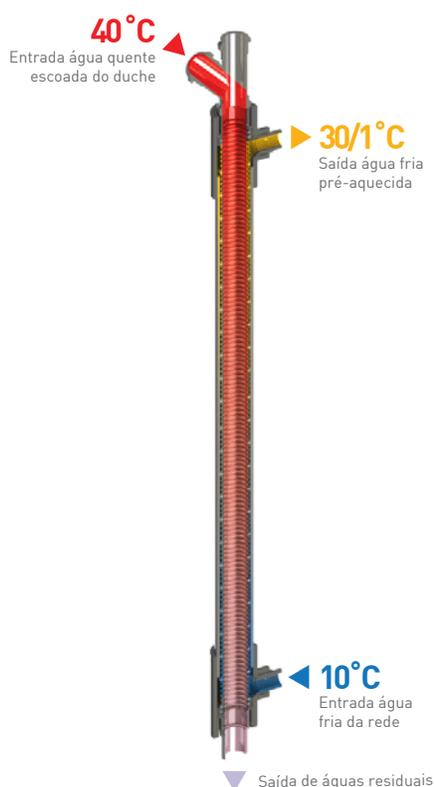
O PiPe 65 é uma solução vertical de recuperação de calor da água do banho, adaptável a bases de duche, calhas de duche ou banheiras, com um caudal recomendado até 12L/min. É capaz de proporcionar uma poupança de energia de 67%. ZYPHO transfere o calor da água desperdiçada do duche para a entrada de água fria. Essa água pré-aquecida é então direcionada à torneira misturadora do chuveiro, ao esquentador de água ou, de preferência a ambos
